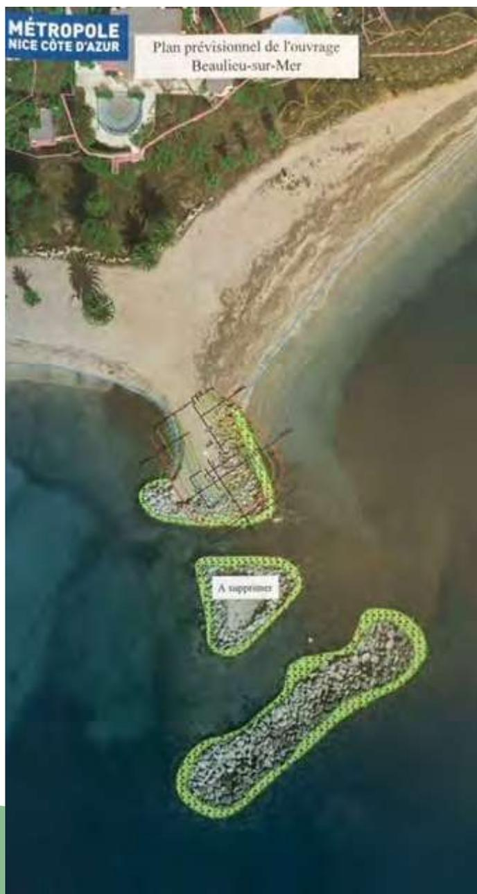
2 400 m<sup>3</sup> d'argile ont été retirés pour élargir l'entrée du plan d'eau au niveau de l'anse. Cette opération permet d'oxygéner les eaux de baignade. Aujourd'hui, l'eau est plus limpide et sa qualité optimale.
